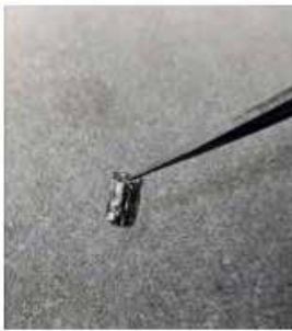
Préparation de collagène d'os pour l'analyse d'isotope. Les échantillons de collagène (en haut) sont pondérés en capsules d'étain de 64 mm ( \approx 0,5 mg par échantillon) (en bas)x
